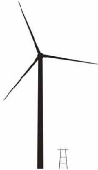
Kuva 3-1. Ote YVA-selostuksesta Kuva 8-26. Tuulivoimala (korkeus noin 150 m) ja voimajohtopylväs (korkeus noin 20 metriä) esitettynä samassa mittakaavassa. Lähde: YVA-selostus, Pöyry Management Consulting Oy, 2010
